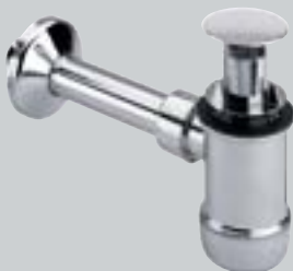
Канализационный сифон полностью хромированный, для раковин без перепускного отверстия. Выдвижной патрубок поднимается на 90 мм
